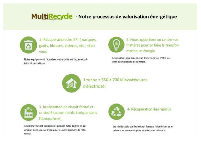
Le traitement implique l'incinération de la matière et ensuite l'extraction du métal. La fibre incinérée devient de l'énergie renouvelable propre, c'est-à-dire de la vapeur qui sera utilisée pour produire de l'électricité. Pour plus de détails: https://www.youtube.com/watch?reload=9&v=-KmTbHlnScw&feature=youtu.be
